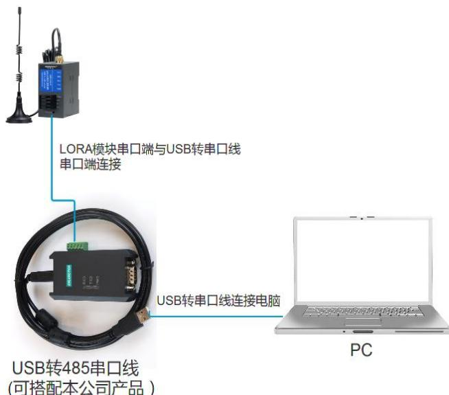
图 5.2 LORA 模块参数设置接线示意图
