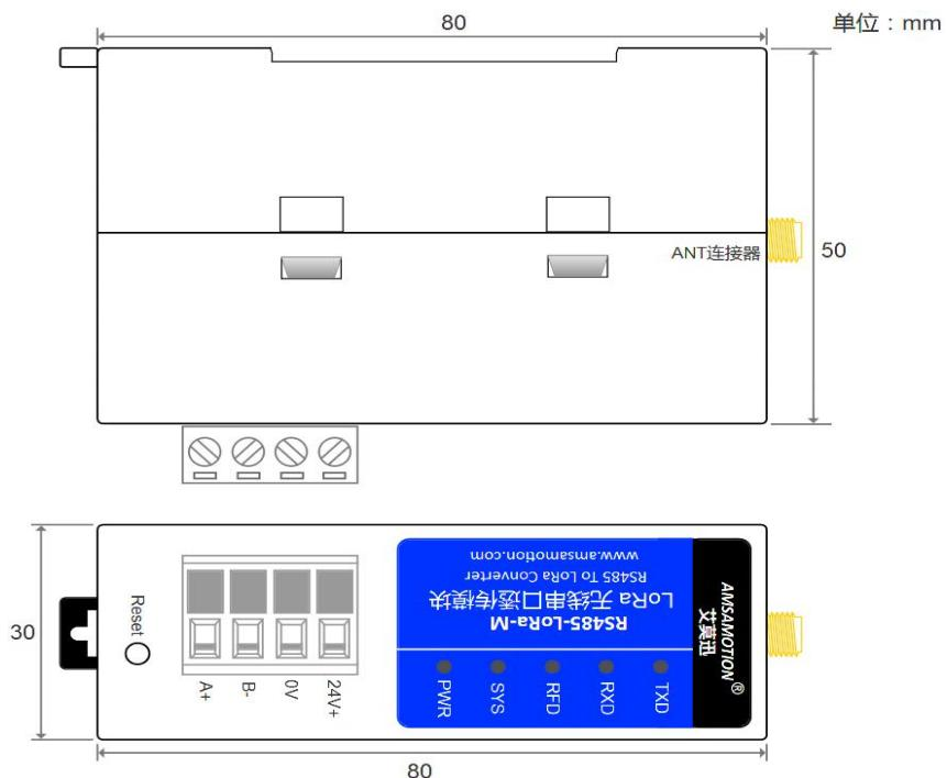
图 3.1 RS485-LORA-M 尺寸图
