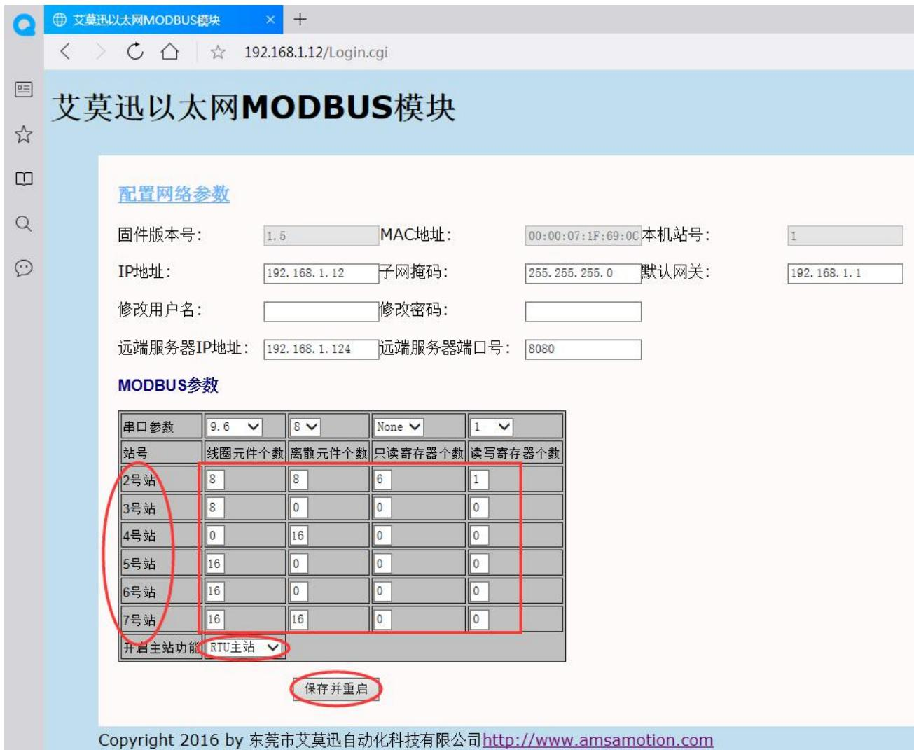
**注意：要 MODBUS TCP 控制多从站可用，还需将 COM2 口模式设置为 RTU 主站。**
