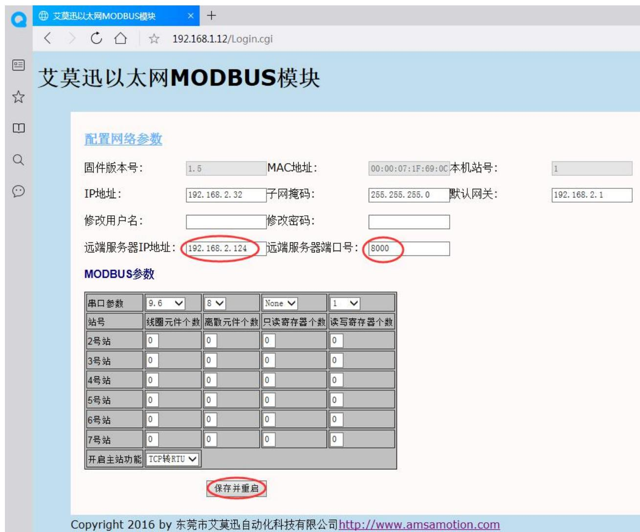
**注意：远端服务器 IP 地址应注意与模块 IP 在同一网段。**
