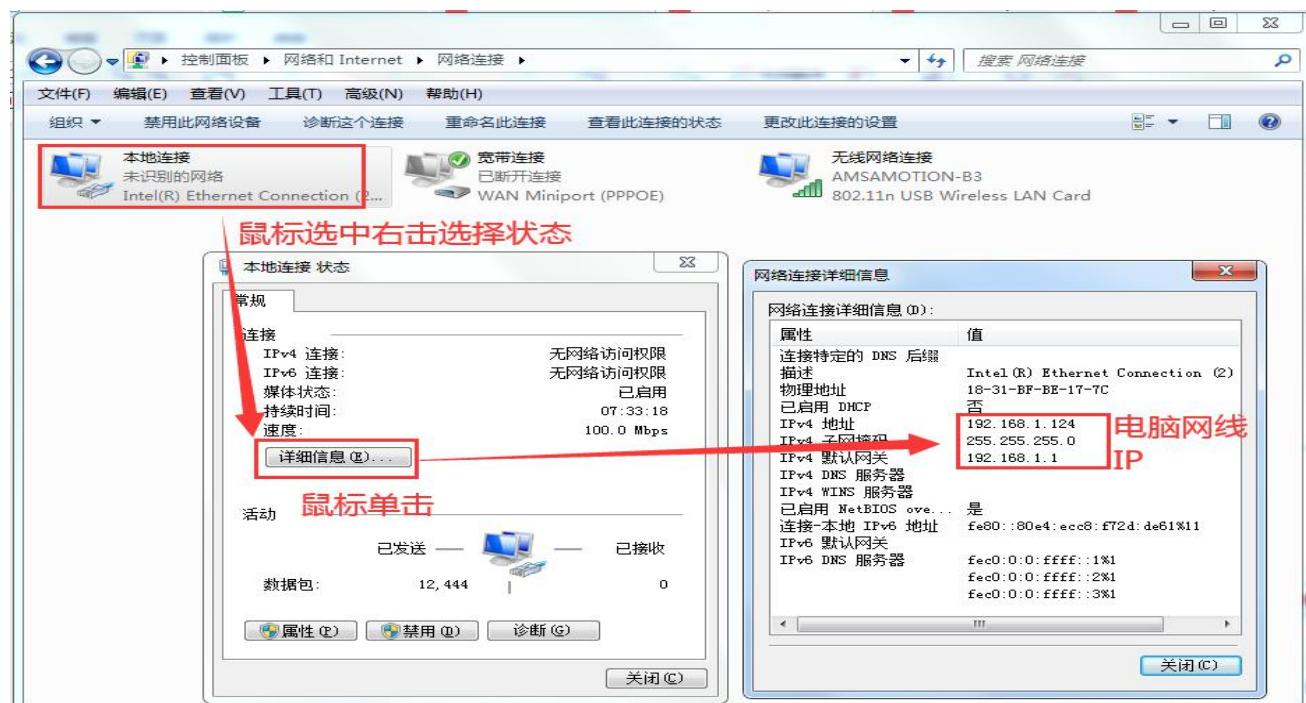
B. 参照下图步骤，将连接模块与电脑的网线网络，设置成与模块同一网段的固定 IP。
