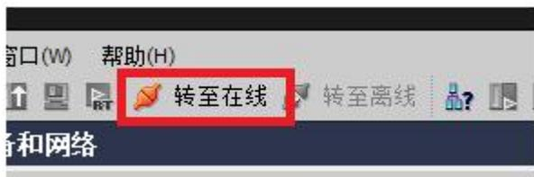
4、选择 PN/IE 点击开始搜索，搜索到设备后点击转至在线。（若没搜索到请检查 IP 地址是否正确，PLC 地址站号是否组态正确，电脑是否能 ping 通模块 IP）
