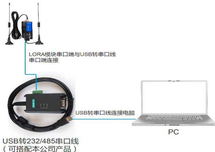
图 5.2 LORA 模块参数设置接线示意图
