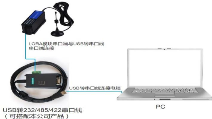
图 5.2 LORA 模块参数设置接线示意图
