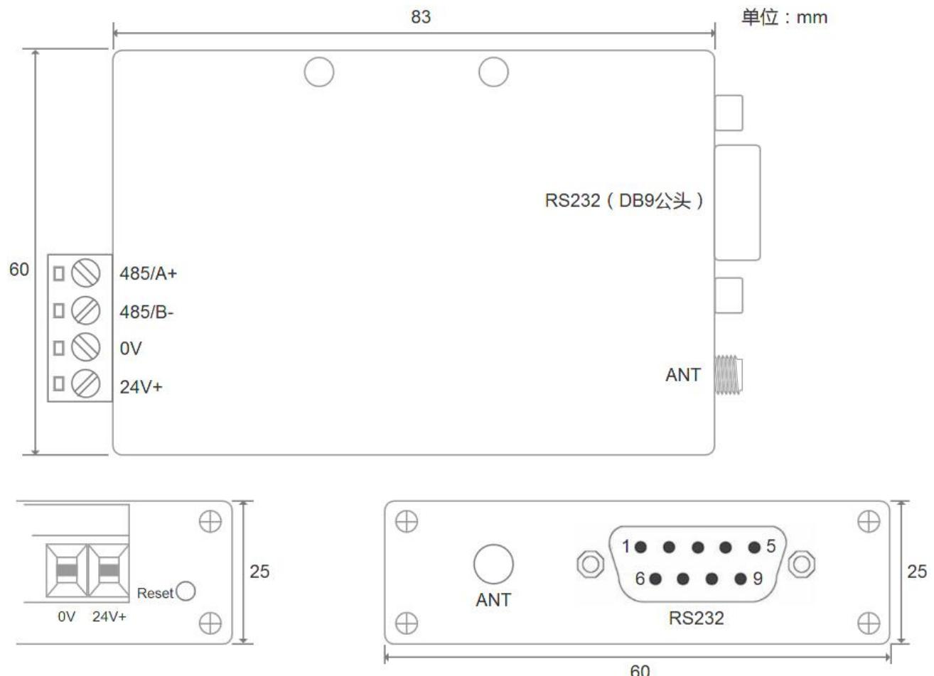
图 3.1 RS232/485-LORA-T 尺寸图
