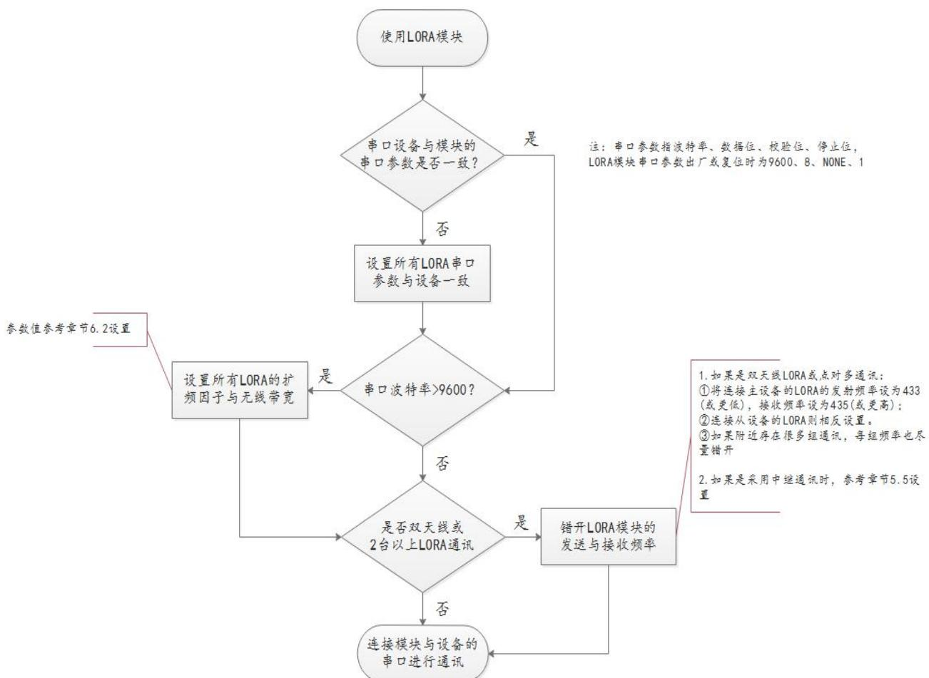
图 4.1 LORA 模块一般使用流程
