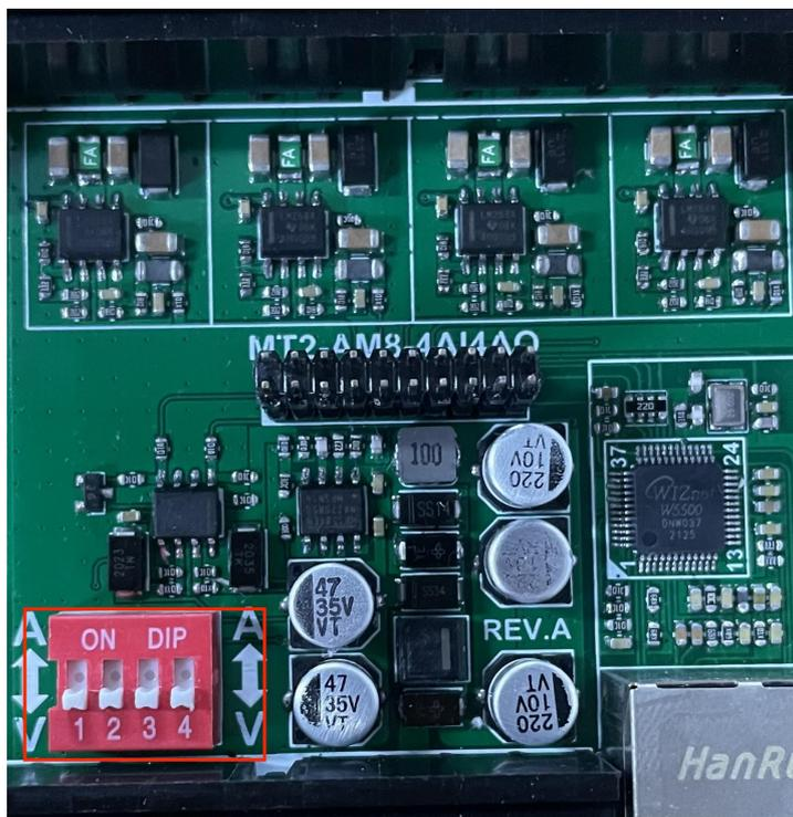
拨码片下方的数字是对应的通道；确定模拟量是电压还是电流，模拟量输入正极接入 IN+ 端口，负极接入 G 端口。接入后，保持接触良好，可在对应的寄存器查看测量到的数值。
