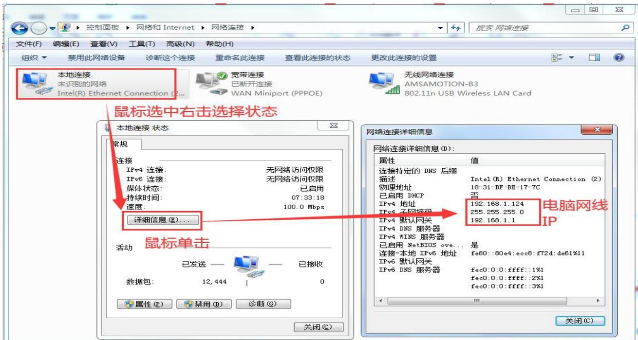
B. 参照下图步骤，将连接模块与电脑的网线网络，设置成与模块同一网段的固定 IP。
