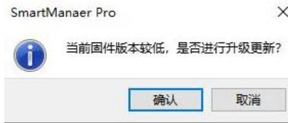
点击确认，等待更新（HMI会重启表示更新完成），然后再继续手动下载工程。
