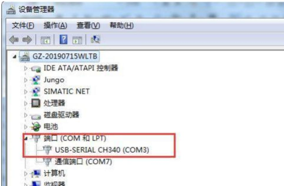
出现 USB-SERIAL-CH340(com3)电缆驱动安装成功。
